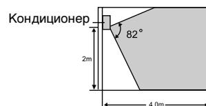
Высота установки кондиционера более 2 м
